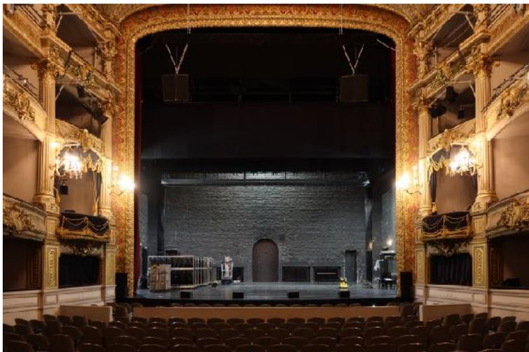
Le plateau est en plancher noir sans pente et d'une capacité de charge de 500 kg par m<sup>2</sup>.
